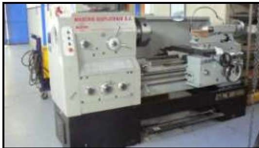
Torno Paralelo 1,5 metros entre puntas sobre elevado
